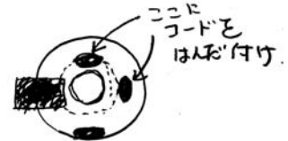
ジャックをネジ部を して上から見た図
