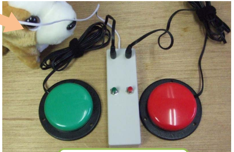
2スイッチ型 電磁リレーを使っています。
