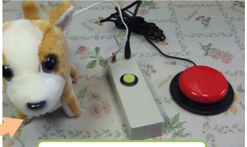
1スイッチ型 トグルスイッチで動作を切り換えます。
